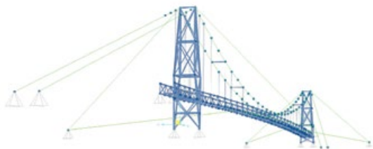
Čelični viseći pješački most raspona 108 m Priječani - Zalužani preko rijeke Vrbas
